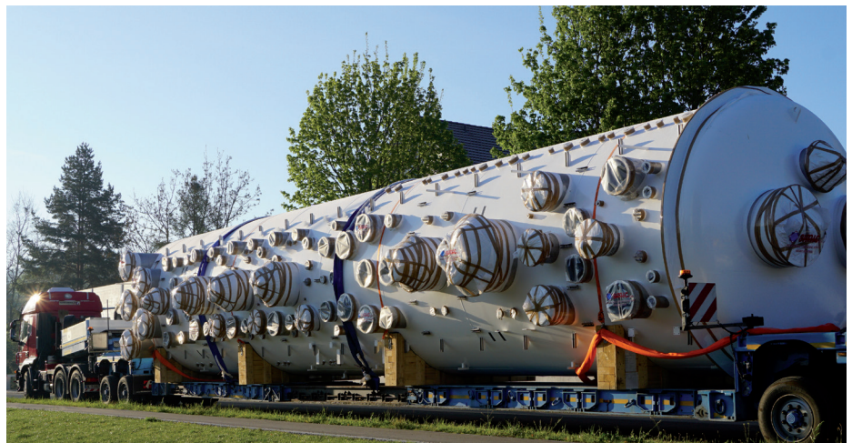
Oben: Aus diesem zylindrischen Rohrschuss, der als Schwertransport mit 100 Tonnen Gesamtgewicht von Italien nach Sirmach geliefert wurde, wird eine Kälteanlage für eine der bedeutendsten Forschungsanlagen in Frankreich hergestellt.
